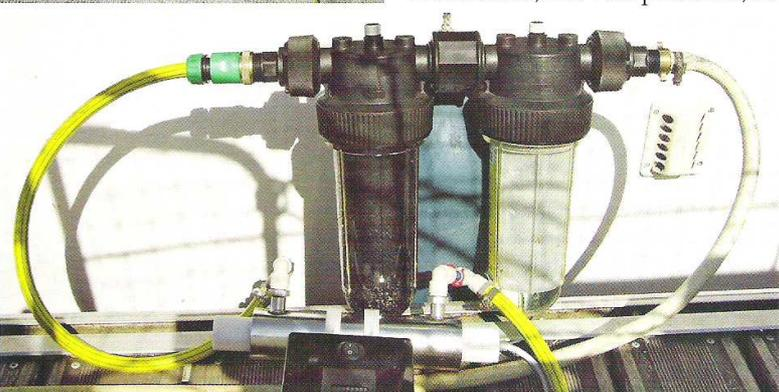
Plutôt que de prendre le risque de fuites, une fois l'ensemble installé dans la cale, mieux vaut tester le dispositif à terre ou sur le catway; le moindre défaut de raccord sera immédiatement mis à jour sous une pression de 2 à 3 bars!
