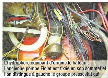
L'hydrophore équipant d'origine le bateau ; l'ancienne pompe Flojet est fixée en son sommet et l'on distingue à gauche le groupe pressostat qui déclenche sa mise en route.
